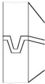
Izvedbe sučeonih spojeva sa žlebom
